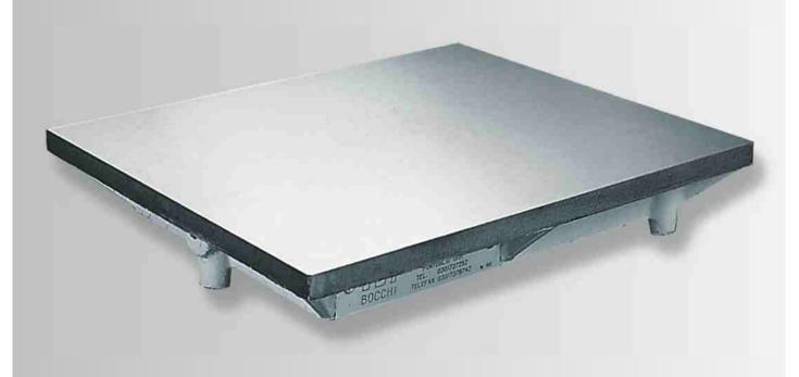
Piano di riscontro in ghisa G25 esente da soffiature o imperfezioni strutturali. La stagionatura della ghisa viene ottenuta naturalmente. La struttura perlitica con appoggi e nervature disposte in modo da poter opportunamente contrastare le tensioni che si verificano quando il piano viene sottoposto a carichi. I bordi sono finiti a macchina ortogonali tra loro e la superficie di riscontro. La superficie del piano è rettificata secondo norma DIN 876/1.
