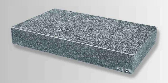
Piano di riscontro in granito nero. Costruito in una struttura omogenea e compatta, di altissima precisione per sale metrologiche. Vista la possibilità di poter ottenere tolleranze estremamente precise i piani in granito presentano innumerevoli vantaggi quali: assoluta resistenza alla corrosione, non magnetici e non conduttori e con usura minima nel tempo. La superficie del piano è lappata. Il grado di esecuzione è extra con tolleranza DIN 876/00.
